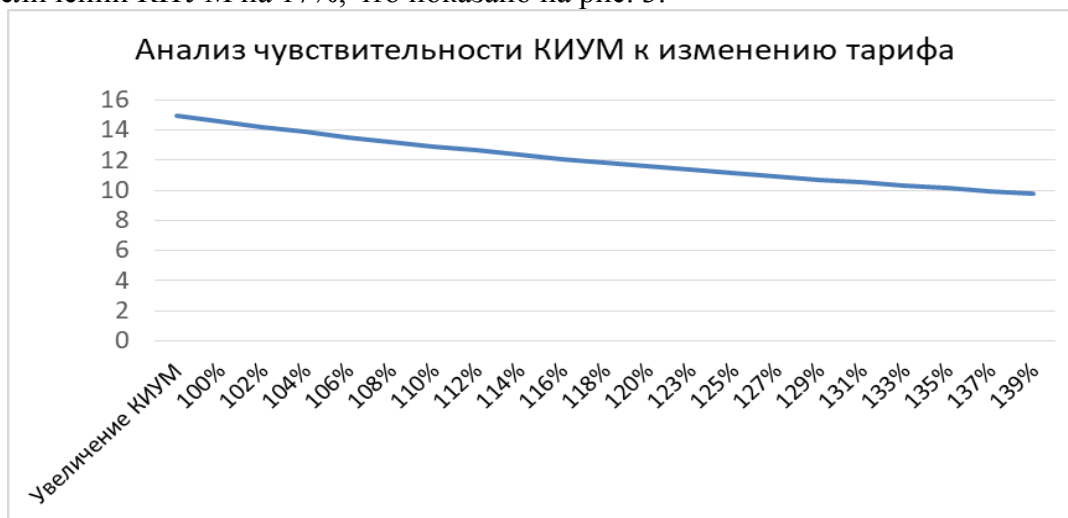
Рис. 3. Анализ чувствительности проекта к изменению производительности солнечной панели (КИУМ)
